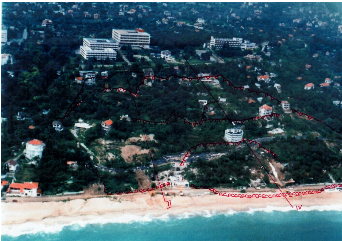
Снимка 3: обзорна снимка на свлачище „Кабакум“ с показани основни отстъпи, вал на изтласкване, местата на геоложки разрези II и IV
